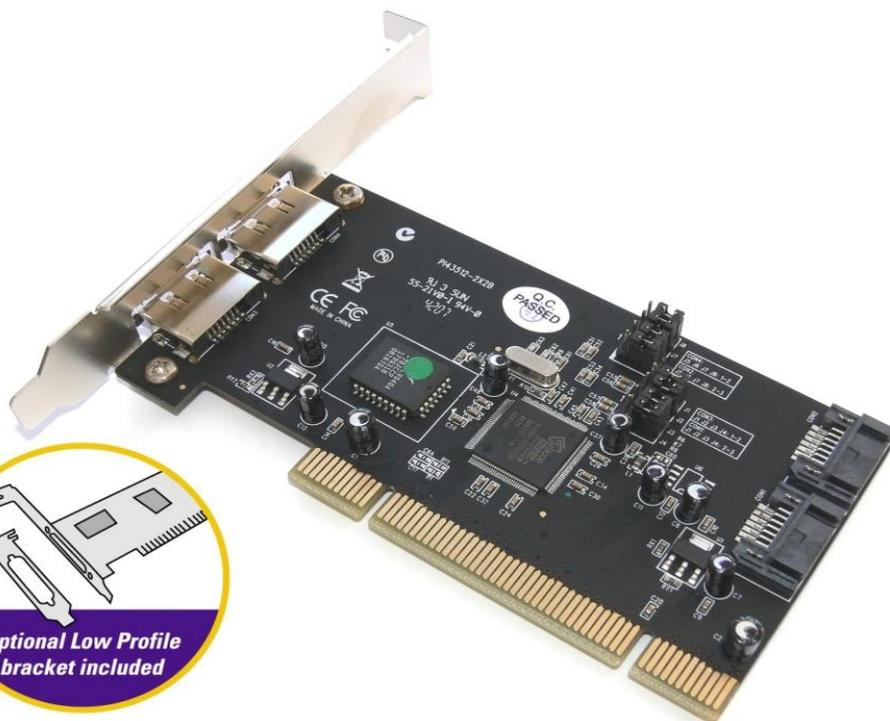
Sandberg SATA Raid Boost consente di espandere il computer con un massimo di due dischi rigidi SATA interni: individualmente in configurazione RAID. Per collegare i dispositivi eSATA come dischi rigidi esterni, è anche possibile utilizzare le due porte eSATA esterne.
